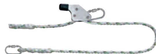
553 76 TENDITORE PER CORDA EN 358 €€ › Caratteristiche: Dotato di corda in poliammide a triplo filo intrecciato, diametro 14 mm, lunghezza 2 m. Con 2 moschettoni Standard.
