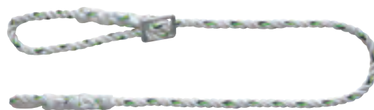
553 50 CORDINO REGOLABILE 2 M EN 358 €€ › Caratteristiche: Cordino regolabile da 1 a 2 m in poliammide a triplo filo intrecciato; diametro 14 mm, con asole.
