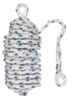
553 59 CORDA 20 M EN 1891 C€ › Caratteristiche: In poliammide triplo filo intrecciato, diametro 15 mm, corredata di asole.
